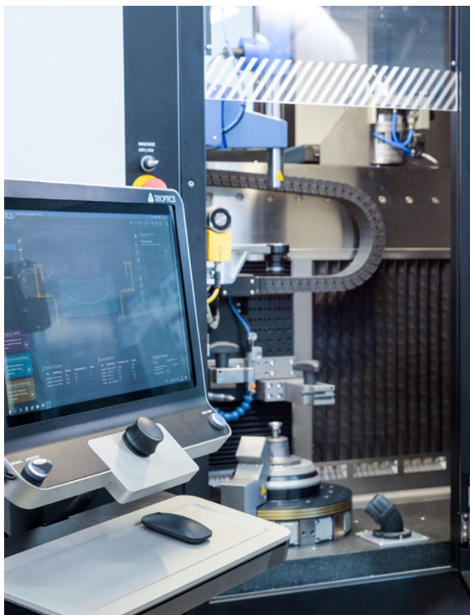
Hochpräzise Positionierung von Optiken: Zentrierdrehen für höchste Genauigkeit und Qualität.
